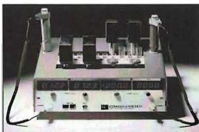
Koagulometr podle Schnitgera a Grosse – schéma
