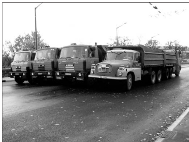
zatěžovací zkouška mostu Pavla Wonky byla provedena osmi naloženými nákladními vozy za přesně stanovených podmínek
