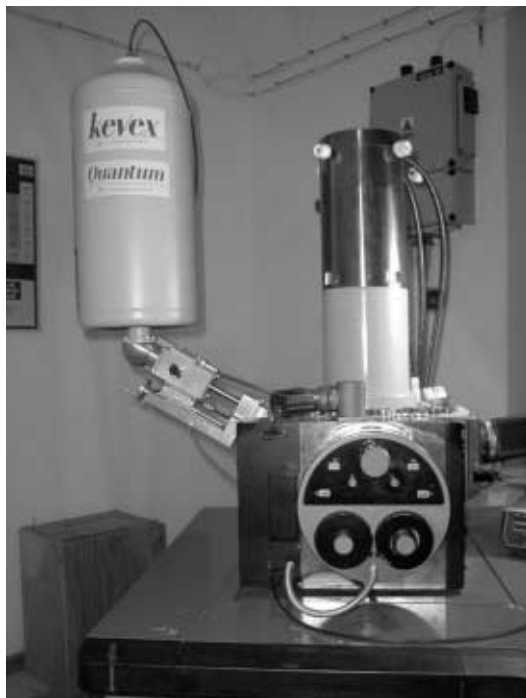
Elektronový mikroskop TESLA BS 340 s energiově -disperzním analýzátorem KeveX. foto: archiv katedry
